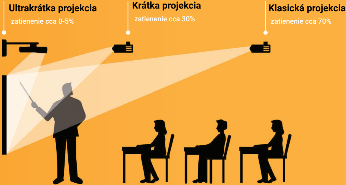
Porovnanie tienenia pri použití projektorov s ultrakrátkou, krátkou a klasickou projekciou.
